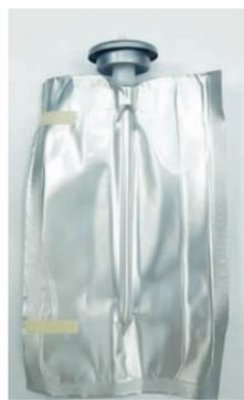
● В цехе наполнения введена в эксплуатацию новая линия по выпуску готовой продукции по технологии bag on valve (BOV). В традиционных аэрозольных продуктах активно действующее вещество (АДВ) контактирует в баллоне с пропеллентом. В произведенных по технологии BOV продуктах АДВ находится в специальном мешке, зафиксированном на клапане. Пропеллент расположен вне мешка в баллоне и не контактирует с АДВ. При нажатии на кнопку активатора, продукт
