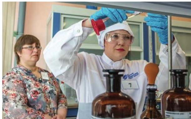
Анастасия Яшкина определяет жесткость воды в контрольном образце по ГОСТу
