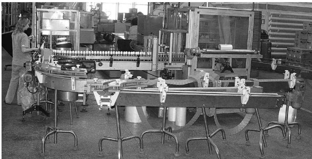
Идет подготовка линии №7 к монтажу машины упаковки французской фирмы Gertex
